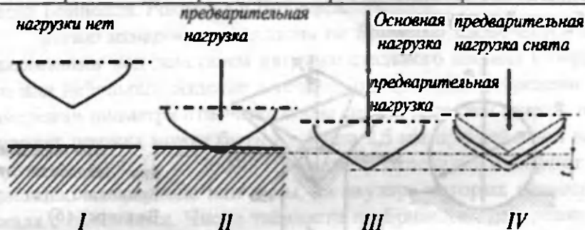
Рис. 9. Определение твёрдости по Роквеллу вдавливанием шарика или конуса: I – IV – последовательность нагружения
