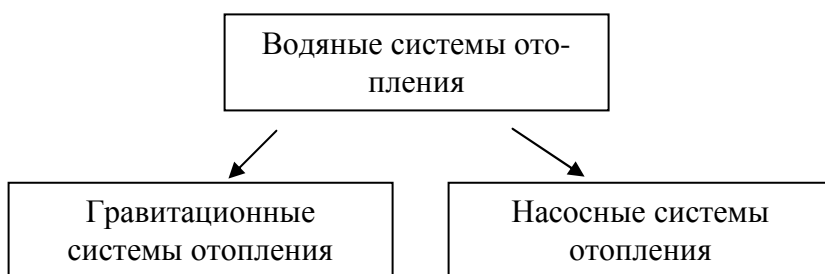
Рис. 2. Виды систем водяного отопления
