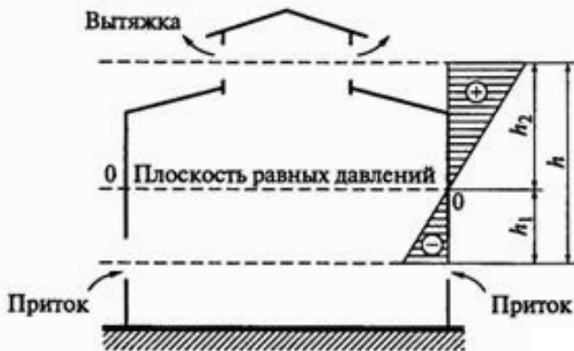
Рис. 4. Схема распределения давления воздуха при естественной вентиляции в промышленном здании
